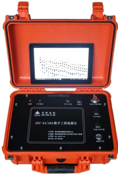
SDZ-XX 系列数字工程地震仪是由重庆顶峰地质勘探仪器有限公司自行研制的在中文 Win10、Win7 系统平台下工作的真 24 位数字地震仪器。它采用当今国内外先进电子技术和设计理念，并结合国内许多用户的使用习惯设计的一款集多功能、高精度、高速度、高可靠性于一体，具有良好的人机交互界面及可扩展性的国内领先地震仪。仪器可使用锤击、落重、电火花、雷管（炸药）爆炸等作为激励震源，勘探深度可达上千米，野外勘探方法有：反射勘探、折射勘探、面波（瑞雷波）勘探、多波地震映像勘探、地脉动（常规微动）测量、建筑和场地震动安全评估、基桩检测、跨孔层析成像（CT）测量及井中剪切波测量等地震勘探方法，广泛应用于交通、水电、路桥、城建等领域的工程地质勘探，也适用于油气、煤田、矿产及地下水等领域的资源勘查。
